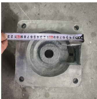
Base de fijación con 4 agujeros – medida en ancho
