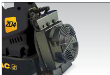
Intercambiador de calor (H)
