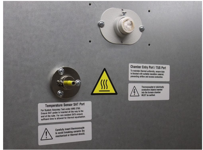
Detalle de puertos SAT (sensor) y TUS (entrada a cámara)
