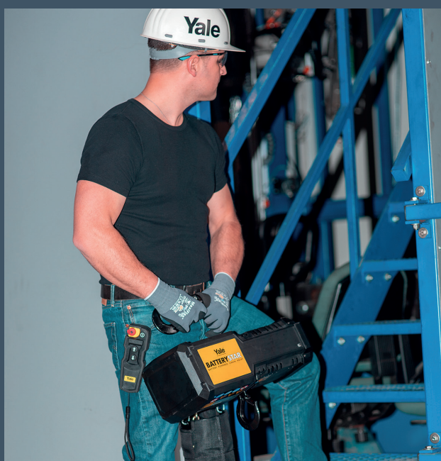
Polipasto ligero y portátil de hasta 1.000 kg de capacidad.
