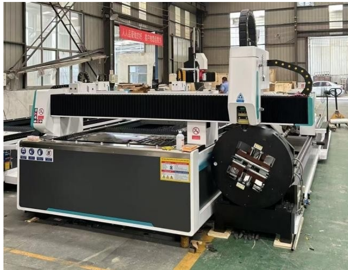
Máquina combinada con mesa de planchas y módulo de corte de tubos con mandril neumático
