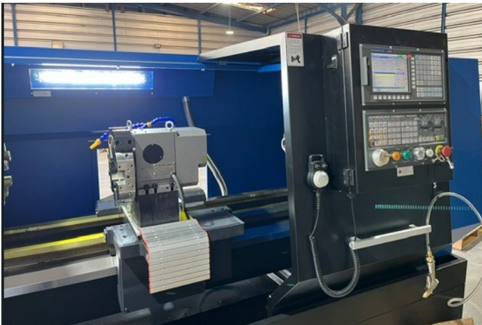
Vista general: carro, torreta y panel de control
